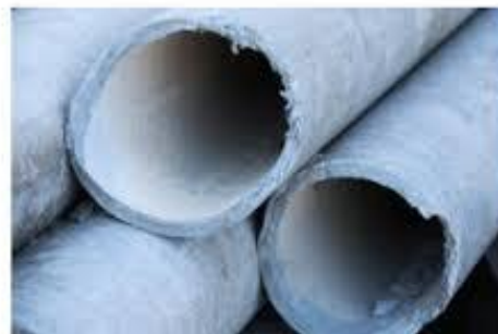
Conductos de agua, canalones, bajantes de fibrocemento
