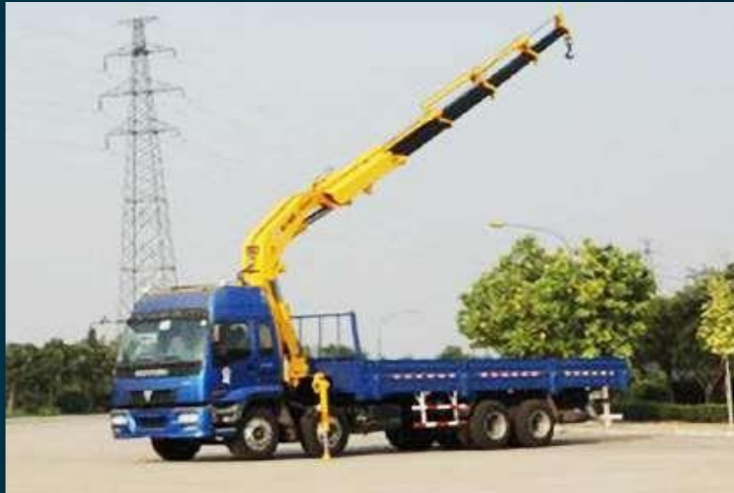
Grúa sobre camión.
